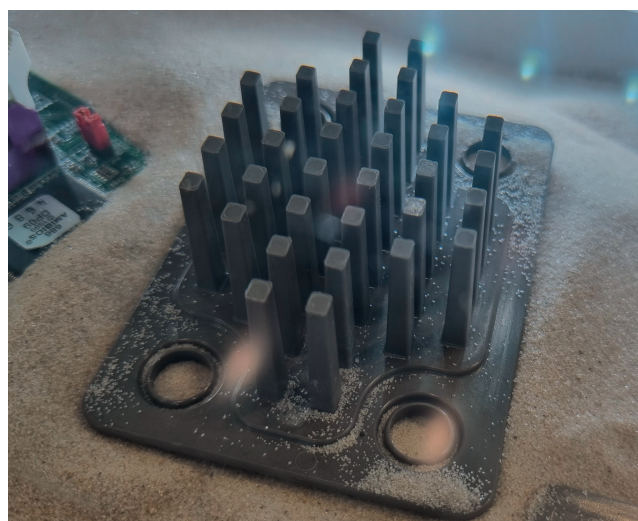
Bild 2. Wärmeleitfähige Kunststoffe werden im Elektronikbereich verstärkt nachgefragt. Sie kommen dort unter anderem für Kühlkörper zum Einsatz.
